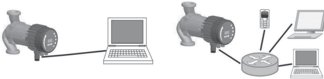
Abbildung 4: Verbindung zu einem Computer mit einem Cross-Over-Kabel Abbildung 5: Verbindung zu einem Netzwerk über einen Router
