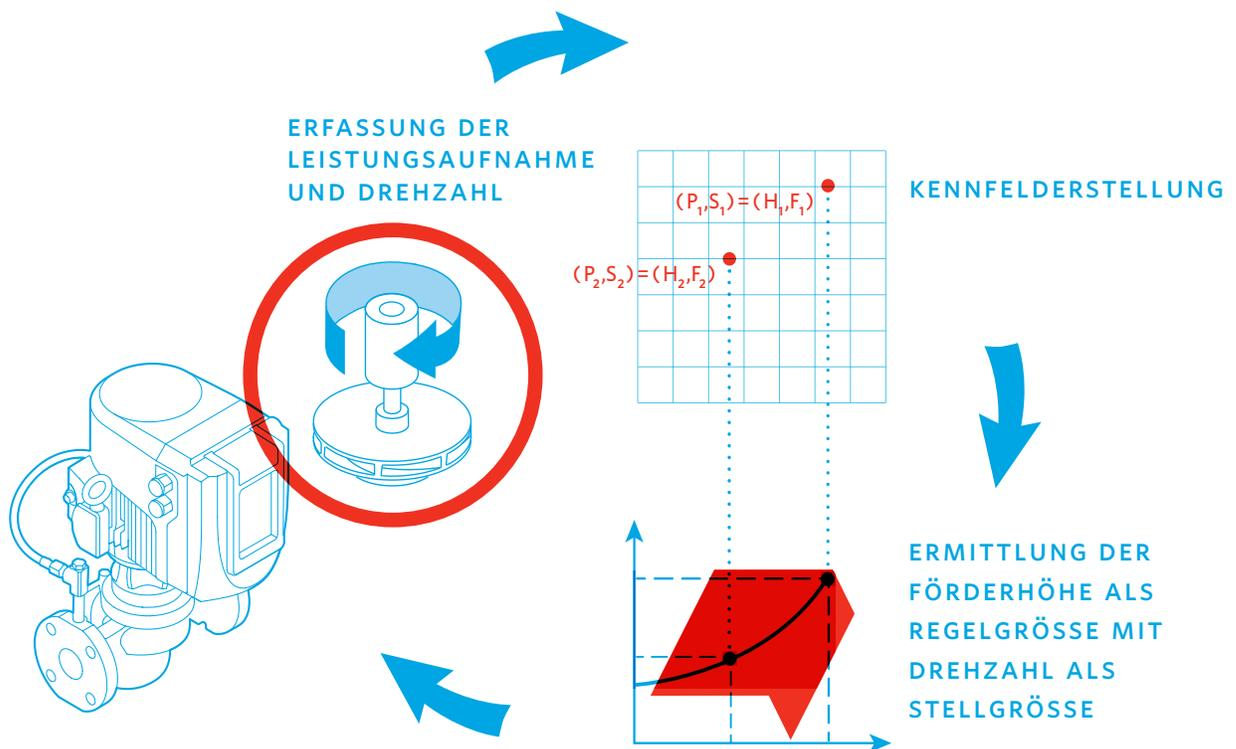
**Dank der Sensorless-Technologie benötigt eine Design Envelope Lösung keinen externen Sensor zur bedarfsgerechten Leistungsanpassung.**
