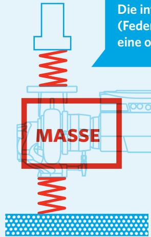
Mit den Kompensatoren zwischen Pumpe und Rohrleitung und den integrierten Schwingelementen als Pumpenfuß ausgeführt, befindet sich die Masse der Pumpe in einem gedämpften Schwingungssystem.
