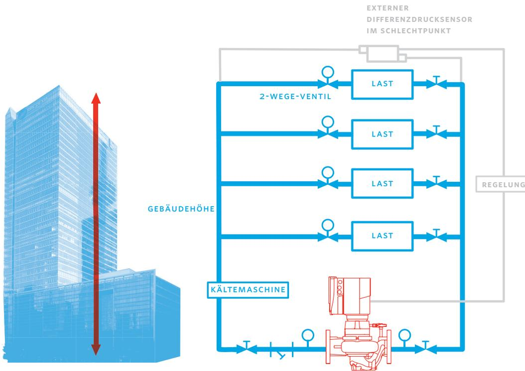
Dank der Sensorless-Technologie benötigt eine Design Envelope Lösung keinen externen Sensor zur bedarfsgerechten Leistungsanpassung
