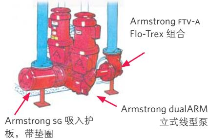
dualARM 立式线型在单入口和出口的一个泵壳内装入了两个泵。使得能用一组管道进行备用或并行运行。泵壳设计和端口阀允许将一个泵拆下进行检修，而另一个泵继续运行。当与吸入护板和 Flo-Trex 阀一起安装时，dualARM 代表了当今 HVAC 商用市场中最长的使用寿命。
