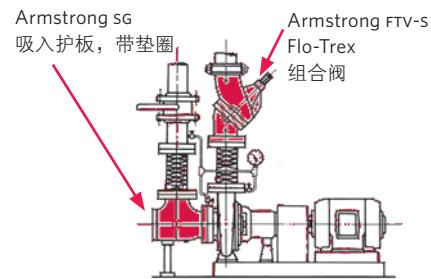
带吸入护板的基座安装泵以及 Flo-Trex 阀，消除了以下成本和空间：
